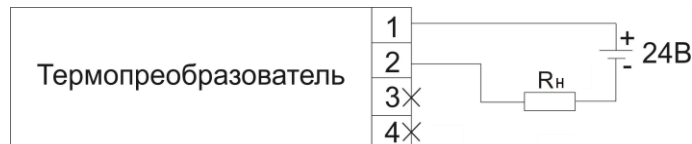
Рисунок 2 – Схема подключения термопреобразователя
