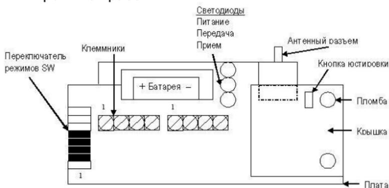
**Рисунок 2 – Вид датчика напряжения и тока унифицированного беспроводного SUI-1.G со снятой верхней крышкой**
